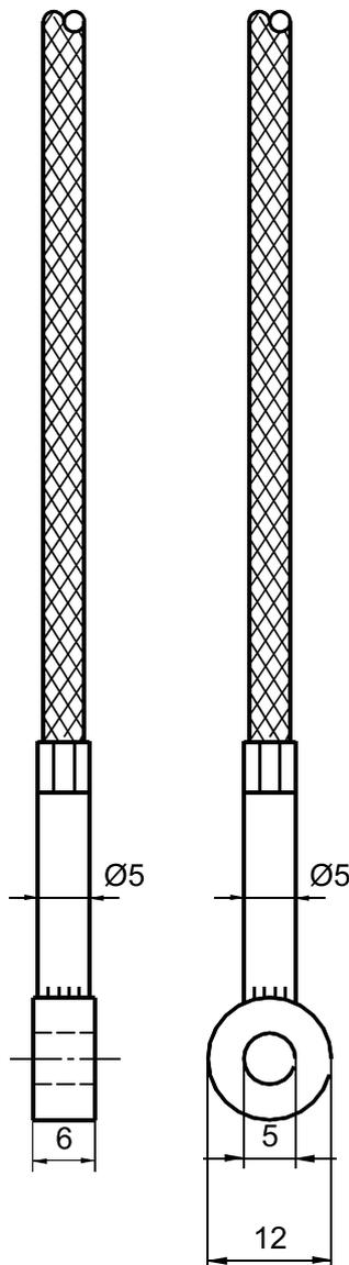
**Thermospannungen :** Fe-CuNi ½ DIN 43710 (L)
