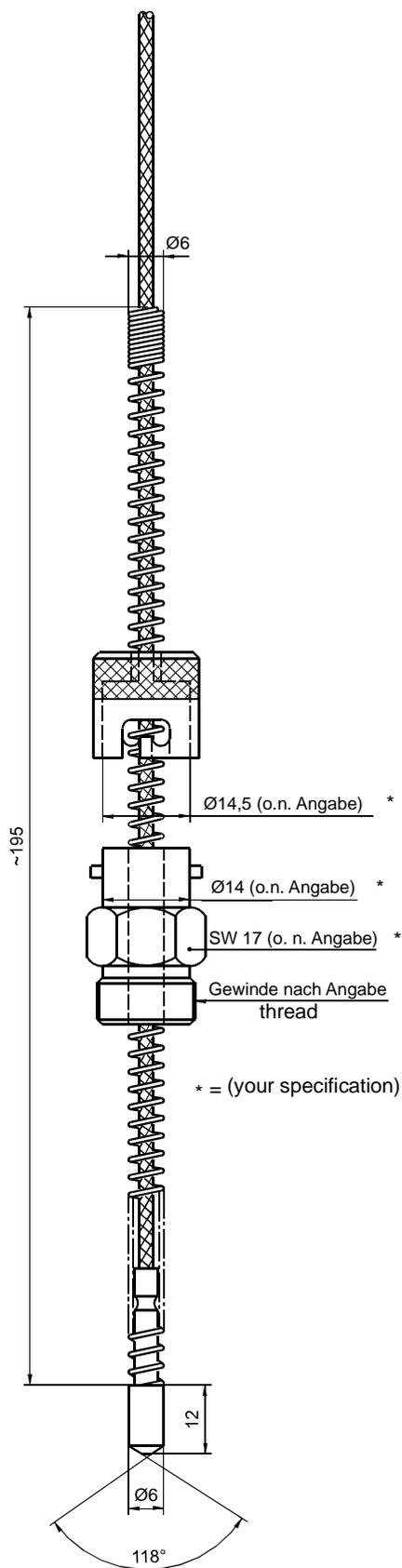
**Thermospannungen :** Fe-CuNi ½ DIN 43710 (L)
